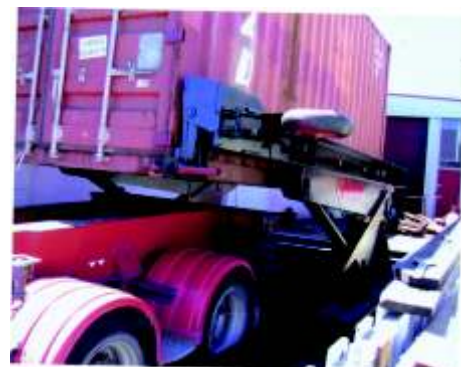
Погрузка контейнера на полуприцеп мобильным кантователем «A-WARD Atm»
