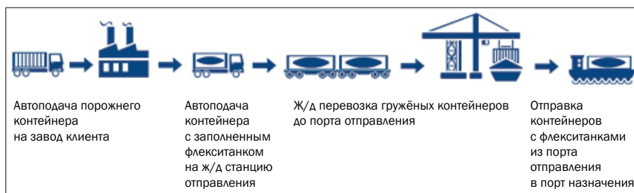
Схема 3. Автоподача контейнера с флекситанком на завод Клиента с последующей ж/д отправкой в порт
