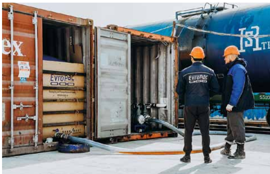
Перевалка наливных грузов на припортовом терминале г. Новороссийска «Вагон-цистерна-контейнер с «флекситанком «Европак»»
