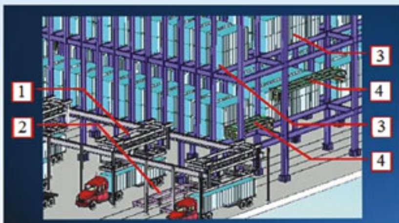
1 — мостовой кран 2 — автоматическая тележка 3 — ячейка для контейнера 4 — лифты-спредеры
