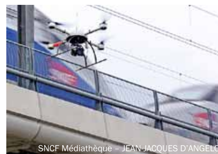
Фото 1. Дрон используется для сбора данных в рамках инспекции виадука Рокмор на ВСМ Париж-Марсель
