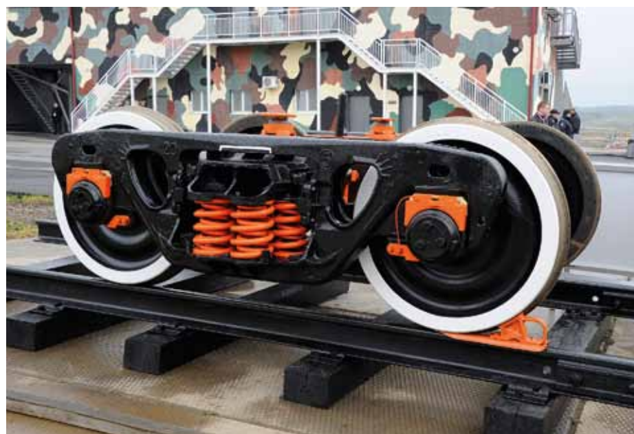
Фото 2. Тележка модели 18-194-1 производства ОАО «Научно-производственная корпорация «Уралвагонзавод» им. Ф.Э. Дзержинского»
