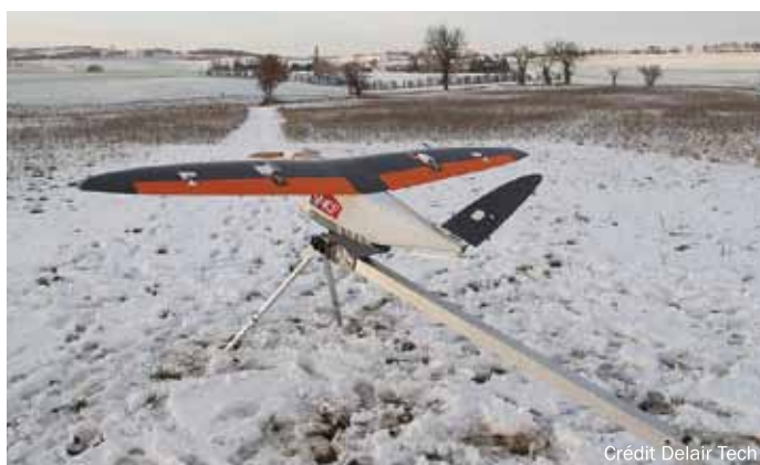
Фото 5. Запуск дрона DT26X в рамках инспекции объектов инфраструктуры
