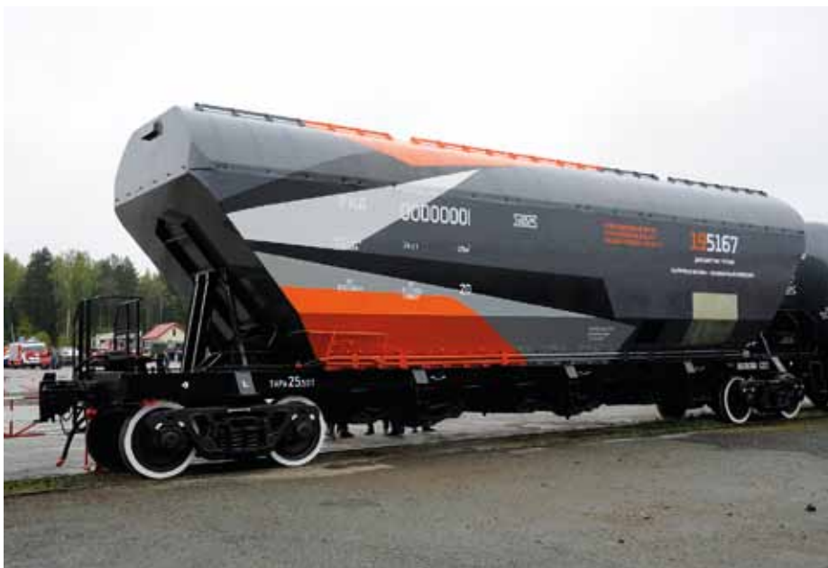
Фото 3. Вагон-хopper для минеральных удобрений модели 19-5167 производства ОАО «Научно-производственная корпорация «Уралвагонзавод» им. Ф.Э. Дзержинского»
