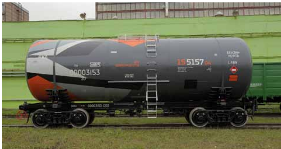
Вагон-цистерна для нефтепродуктов модели 15-5157-04 производства АО «НПК Уралвагонзавод»
