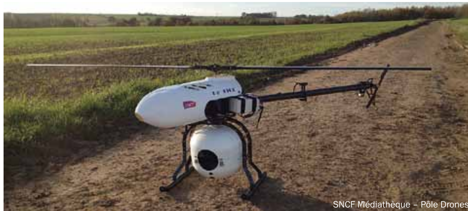
Фото 4. Вертолёт Helipse HE190, предназначенный для обследования природных сред (каменистых откосов, выемок, насыпей)
