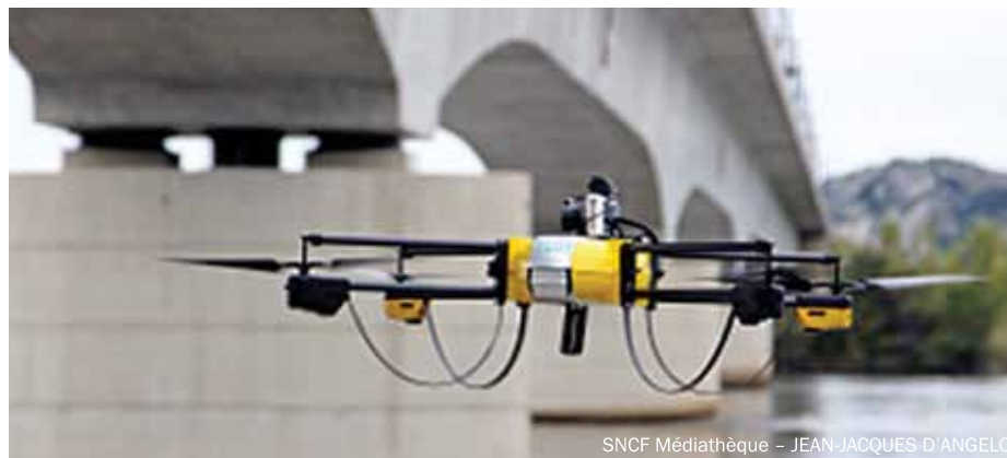
Фото 2. Четырёхмоторный дрон выполняет технический осмотр виадука Рокмор на ВСМ Париж-Марсель
