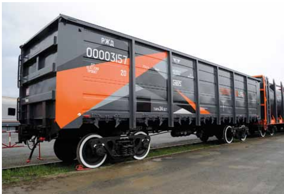
Фото 1. Инновационный вагон модели 12-196-01 производства ОАО «Научно-производственная корпорация «Уралвагонзавод» им. Ф.Э. Дзержинского»
