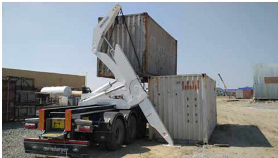
Фото 5. БПК штабелирует контейнеры в два яруса на грунте (Казахстан)
