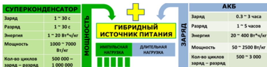
Рис. 7. «Гибридный» накопитель в составе аккумуляторная батарея-суперконденсатор
