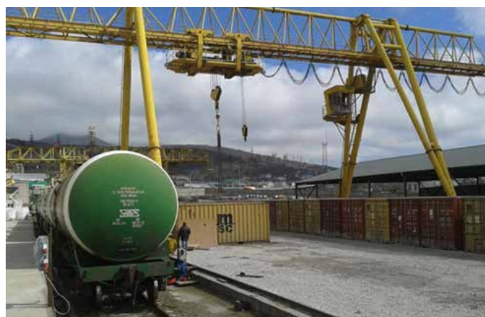
Фото 2. Погрузка контейнеров козловым краном связана с потерями времени и небезопасна
