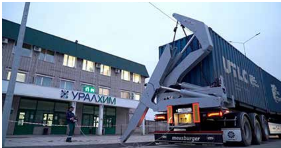
Фото 4. БПК STEELBRO на погрузке в Кирово-Чепецке
