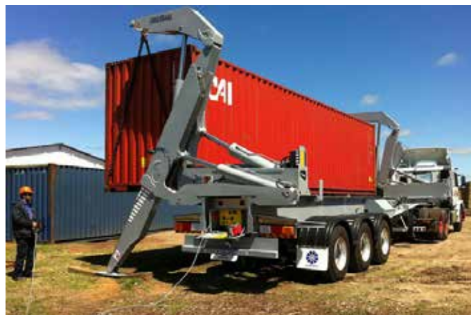
Фото 3. БПК может работать на любой поверхности грунта
