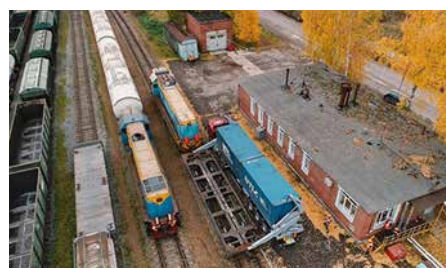
Фото 7. Тестовая погрузка двух 20 футовых контейнеров одновременно на платформу в Кирово-Чепецке
