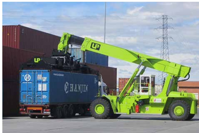
Фото 1. Работа ричстакера требует ровной бетонной поверхности
