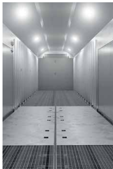
Внутренняя поверхность АРВ — 100% пищевая «нержавейка»
